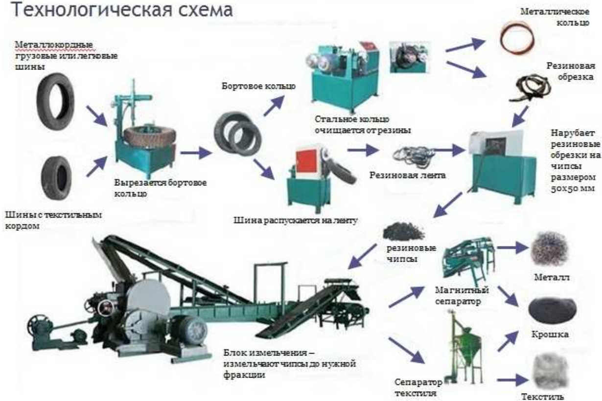
Рисунок 2.11 — Технологическая схема по утилизации изделий из резины, потерявших потребительские свойства (шин, покрышек, камер резиновых) в резиновую крошку ([111])
