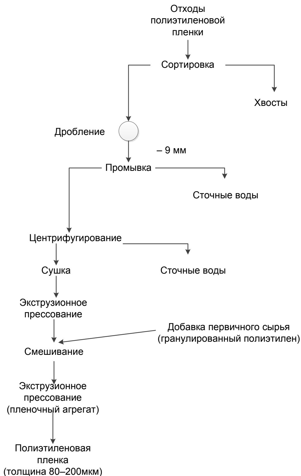
Рисунок 2.16 — Схема переработки отходов полиэтиленовой пленки с применением экструзионного прессования.
